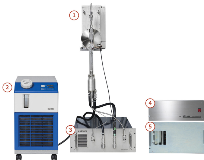
1) X線源ヘッド 2) チラー 3) ジェットポンプモジュール 4) 電源モジュール 5) 高圧電源
