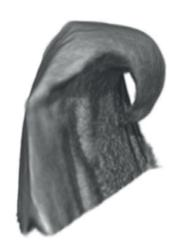
ExcillumのメタルジェットX線源を用いたX線顕微鏡による、損傷した注入カニューラの屈曲先端およそ4 µmの先端部分のCTの容積レンダリング。Voxelサイズは147 nmでした。
